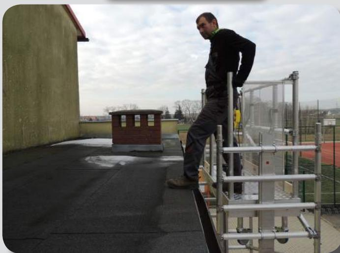
In certe condizioni può essere anche usato come sistema di accesso e di sbarco in quota (tetto, copertura, piano).
