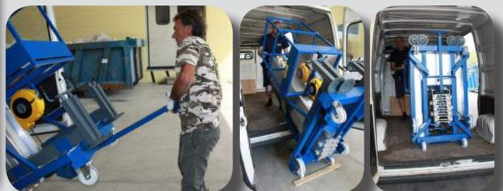
Sistema di carico su automezzo con slitta e barra di ribaltamento
