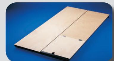
**7) L' "Impalcato"** consiste in due telai indipendenti inferiori che forniscono un sicuro piano di appoggio realizzato in alluminio nervato o acciaio zincato contro la ruggine. Sui telai sono inchiodati due piani di calpestio in legno, resistenti agli agenti atmosferici e completati da 4 tavole fermapiedi. Una botola permette un sicuro e veloce passaggio degli addetti all'interno del trabattello. Per la conformità alle norme europee vedi tabella ed indicazioni a pag. 10.
